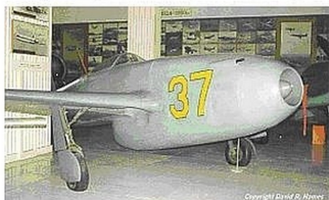
Рис. 10. Як-15 с двигателем РД-10
