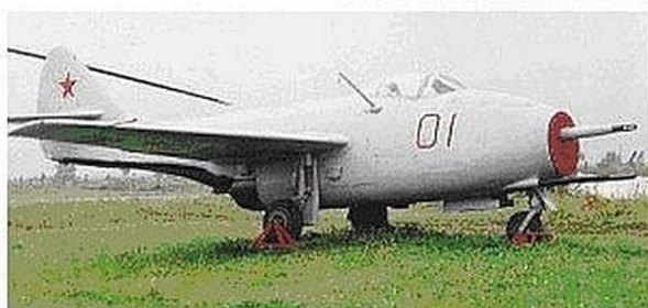
Рис. 12. МиГ-9 с двумя двигателями РД-20
